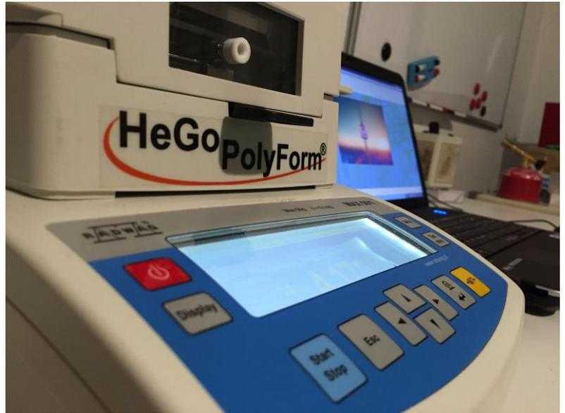
Max. Belastung des Feuchtebestimmers MAX beträgt 50 g/0,1 mg (60 g/1 mg). Die Messung der Feuchte mit der Genauigkeit 0,001% oder 0,0001%. Max. Trocknungstemperatur 160°C (optional Feuchtebestimmer mit max. Trocknungstemperatur 250°C - keine Standardausrüstung).
